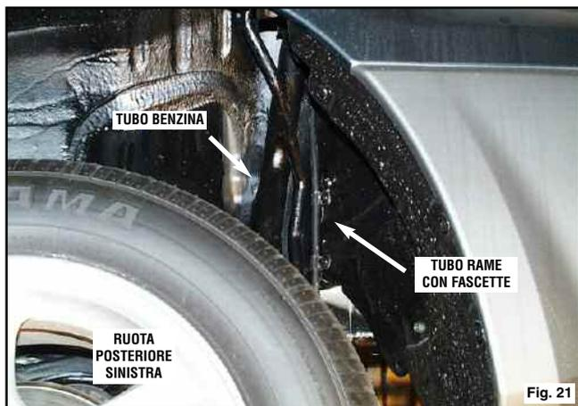
Utilizzando le apposite fascette fissare il tubo rame lungo il suo percorso.
