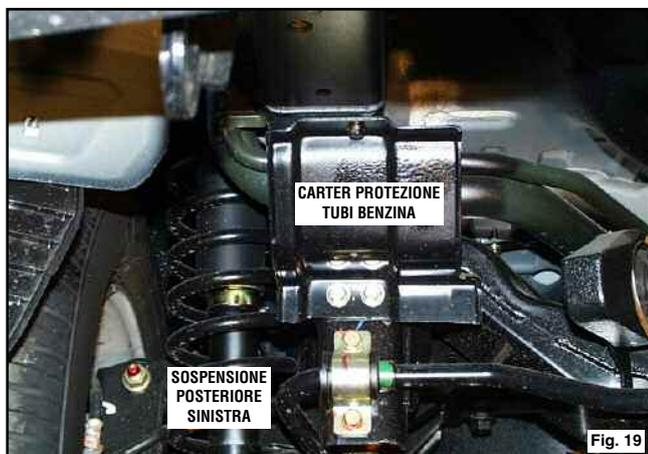
Smontare il carter di protezione tubi benzina (fig. 19).
